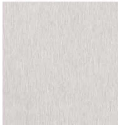
Acciaio Inox satinato AISI 304 o AISI 316
